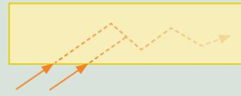
Der frei hängende poröse Absorber absorbiert Schall auf höchstem Niveau.
