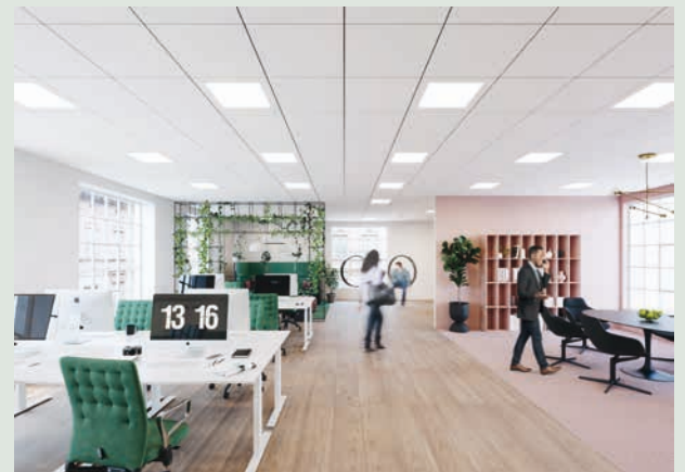
Eine vollflächig verlegte Akustikdecke (hier Ecophon Focus Dg) sorgt für eine ausgewogene Grundversorgung der Absorption im Raum. Foto: Studio 3DSuperlab für Ecophon
